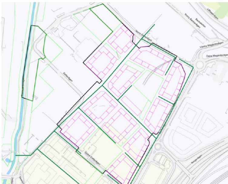
Figur 39. Översikt av principer för det framtida ledningsnätet. Gröna linjer visar dagvattenledningarna. Ledningarnas läge är ungefärliga (KoV 22-05-31)
