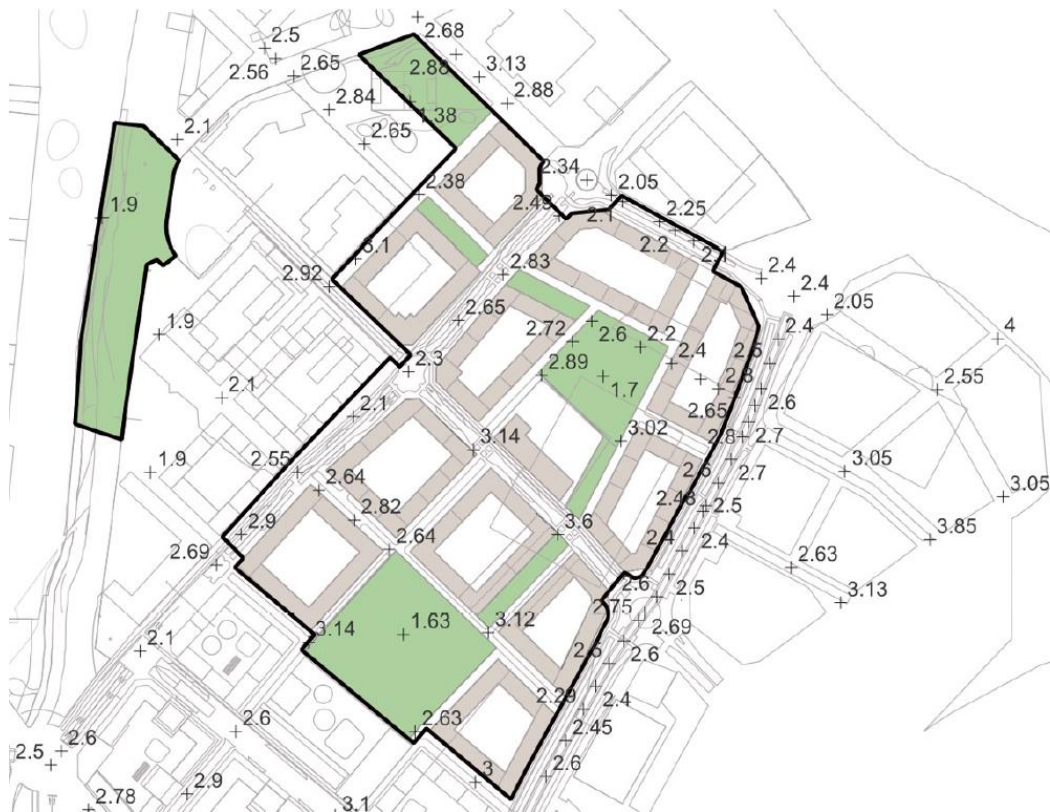
Figur 19. Höjdsättning av gatornas gator och parker i och kring DP3 (KoV 2022-05-31). Tidigare plangräns.
