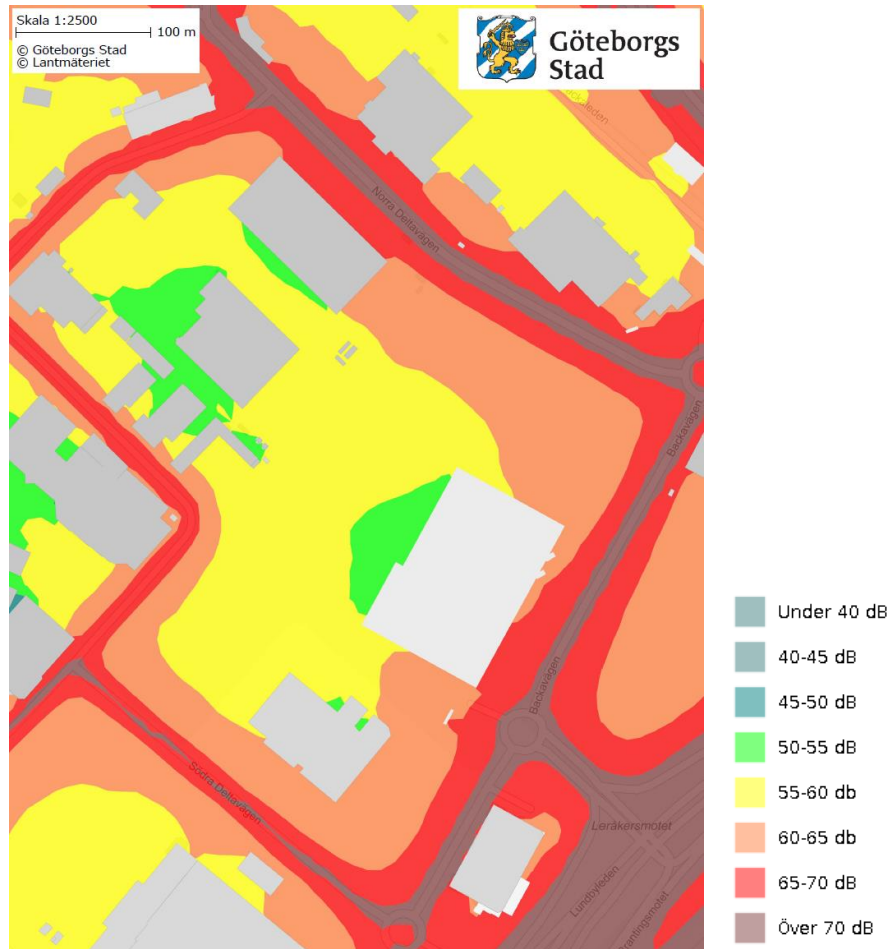
Figur 17. Karta över befintlig bullerutbredningen inom planområdet ur stadens kartsystem Gokart. Beräknat på 2018 års trafikdata.
